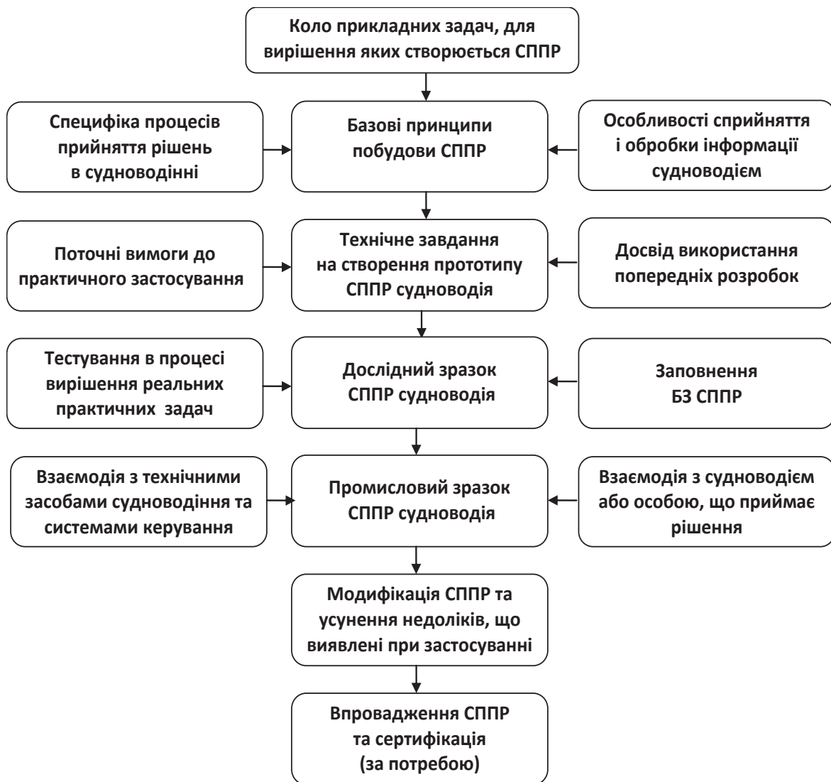
Рисунок 2 – Життєвий цикл СППР у судноводінні
