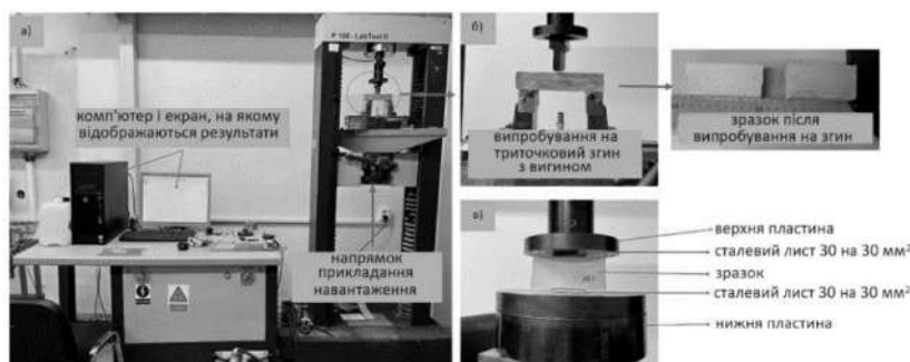
Рисунок 7 – Установка для стрес-тестування: а) випробувальна машина Instron моделі 4202, б) установка для випробувань на вигин, в) установка для випробування на стиск
