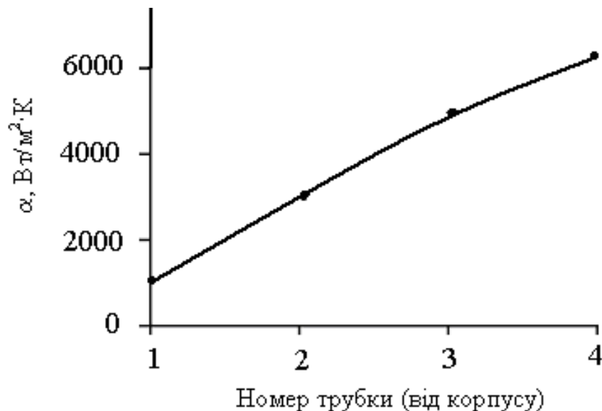
Рисунок 4 – Вплив положення трубки на величину коефіцієнта тепловіддачі
