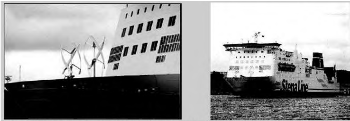
Рисунок 14 – Установка вітрових електрогенераторів на поромі Stena Jutlandica
